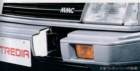
大型ウレタンバンパの断面
