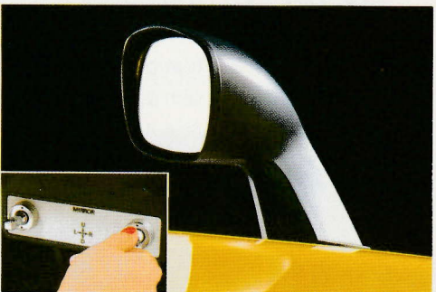
新採用の電動リモコンミラー。ミラーの角度を運転席から調整できます。(Lシリーズ)
