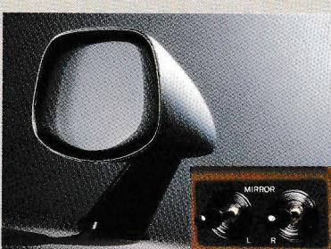
電動式リモコンミラー 運転席からミラーの角度調整ができる。SE・Sにオプション。
