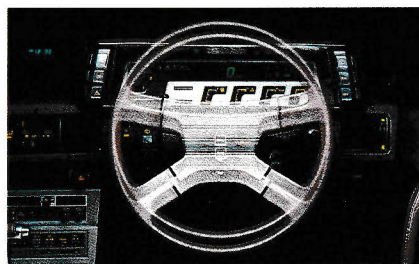
上下25mmに調節できるチルトハンドル
