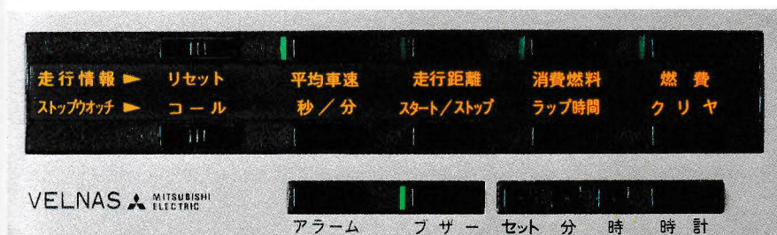
コンピュータがさまざまなドライブ情報を提供するベルナス(VELNAS=Vehicle Electronic Navigation System)
