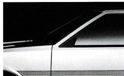
30°のローウインドアングルで空気抵抗を低減
