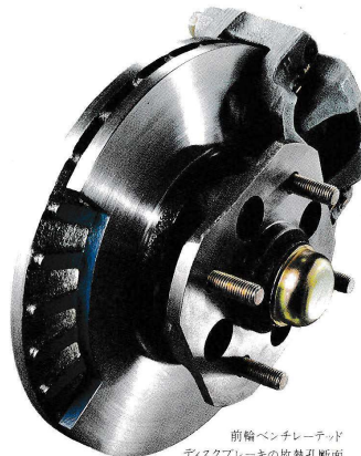
前輪ベンチレーテッド ディスクブレーキの放熱孔断面
