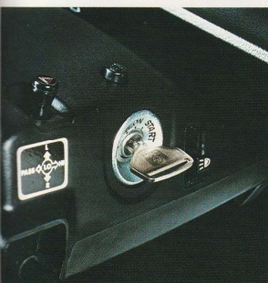
●2操作式ステアリングロック 車の盗難防止に役立ちます。走行中に誤ってロックしないよう安全ボタンつきです。全車標準。
