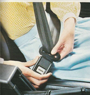
●連続ウェビングシートベルト 肩ベルトと腰ベルトを一体化、簡単に脱着できる3点式です。前2席、全車に標準装備です。
