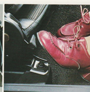
●助手席ウォークイン機構 後席側の足踏み式レバーで、前席の背もたれが前方に倒れてスライド。乗降りがラク。全車に標準。
