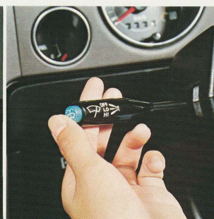
●ワイパースイッチレバー 2速ワイパーとウォッシャーのスイッチを一体化。指先を伸ばすだけで簡単に操作。全車に標準。
