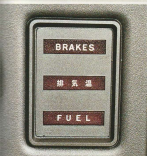
●ウォーニングランプ 燃料の残量、ブレーキオイルの液面低下を警告します。排気温度ウォーニングランプ(TTC-L)を装着する車種は1200cc。
