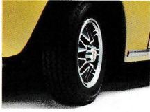
ワイドラジアルタイヤ(LSタイプS、タイプX、G)。偏平率70%。安定したロードホールディングが得られます。
