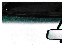
新採用のサンシェードグラス(タイプG)。余分な光線をカットし、走行中のまぶしさを防ぎます。
