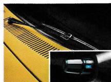
間けつ式ワイパー(タイプS、X、G)。約6秒ごとに間けつ作動。高速型ブレード付です。
