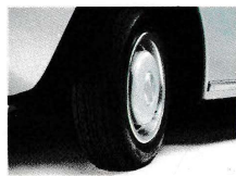
ワイドタイヤ——リブパターン(LS、LSタイプL)。偏平率78%。悪路でも高速でも路面をしっかりグリップします。
