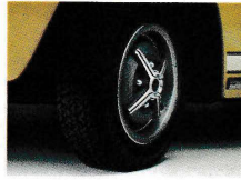
スチールラジアルタイヤ(LSEタイプS)。偏平率は70%。耐久性と安全性にすぐれ、難路も確実に走破します。
