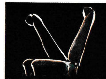
助手席ウォークイン機構。レバーを引くと座席が傾斜し、前にスライドします。後席への乗り降りに便利。(全車)
