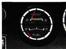
エコノメーター(タイプL)。緑のエコノミーゾーンを守って走ると、燃料が節約できます。
