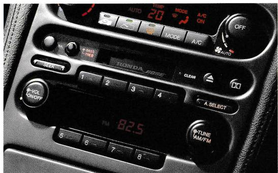
が最良のリスニングポイントとなるよう、専用のイコライザーとアンプをエンクロージャー・ボックスに納めた4スピーカー(前後左右)+AM/FMチューナー、カセットデッキシステムを完成。ライブ感覚にあふれたダイナミックな音響空間の創造をめざした。
