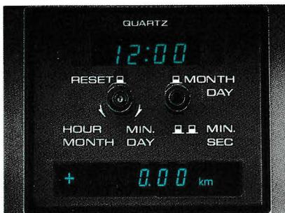
●美しい蛍光発色表示の蛍光管式デジタル時計。精度の高い水晶発振式。GFとSSS系に装備。写真はSSS-EXGタイプです。
