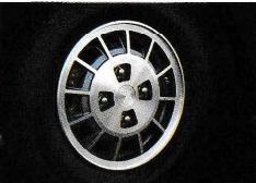
アルホイール 足もとをダンディに引き締めます。パネ下重量の軽減により、乗り心地、走行安定性はさらに向上。
