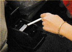
後席灰皿 後席の左右どちらからでも使えます。1400GL以上はコンソール後端に、その他は駐車ブレーキカバーに。
