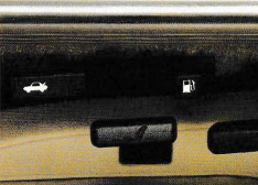
トランクリッド/フェルエルリッドオープン ナ トランクと燃料給油口の蓋を運転席からの操作で開けられます。(トランクリッドオープナは1200GL以上、フェルエルリッドオープナは1400GL)
