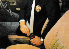
ELR付シートベルト(前席) 衝突時にベルトが早くロックします。通常は身体の動きでベルトがのびます。(GL、SL、XL)
