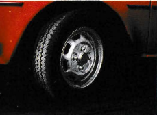
スチールラジアルタイヤ 走行安定性、ブレーキ性能、耐パンク性能にすぐれた安全で高性能なタイヤです。(1400ELと1400SL以上)
