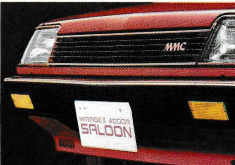
大型バンパ&フロントスカート 軽い接触にも耐えるPP樹脂バンパ。フロントスカートは空気抵抗、空気揚力を低減。
