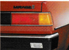
リヤコンビネーションランプ サイドまで回り込んだ視認性の高い大型タイプ。トランクルームの照明も兼ねます。
