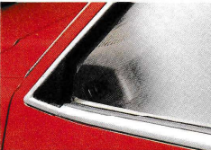
サイドデミスタ 運転席と助手席側のサイドウインドの曇りを温風で除去。雨の日にもクリアな視界を生みます。
