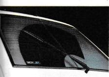
ウォッシャ付リヤワイパー 拡拭面積が大きく、雨天時でもクリアな後方視界を確保します。ウォッシャノズルはゲート間に設置。
