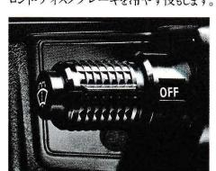
ワイパー・スイッチ 小雨時などに威力を発揮する間けつワイパー機構付でも操作のしやすい大型ロータリースイッチです。
