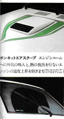
ボンネットエアスクープ エンジンルームへの外気の吸込と、熱の放出を行ないエンジンの温度上昇を防ぎます(オプション)。
