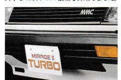
大型フロントスカート 空気抵抗を同時に揚力を低減し、走行安定性を発揮。フロント・ディスクブレーキを冷やす役もします。
