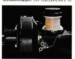
フロント・ディスクブレーキ 放熱性に優れ、水はけもよいディスクブレーキ。いつでも確実なブレーキングを行なえる7インチの大型マスターパックを採用しました。
