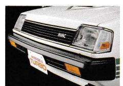
PP樹脂大型バンパ 万一の衝突時にも安全性が高い大型バンパでも接触時の衝撃を吸収するPP樹脂を採用しました。
