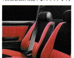
フロントELR付シートベルト 衝突時には自動的にロックする、安全な車体感知式ELR機構が付いた3点自立式です。
