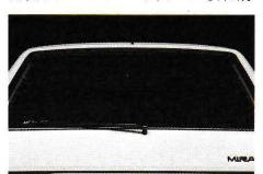
熱線プリントリヤウインド スイッチひとつで、リヤウインドの暑さをスピーディに取り除き、クリアな後方視界を確保します。
