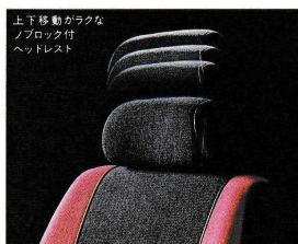
安全性の高いソブロック付縫製ヘッドレスト。ヘッドレストは、ストッパーレバーの操作によって、スムーズに上下移動できます。ドライバーに最もっともフィットする位置を選べますから、万一の時にショックが少なくてすみます。乗り降りをよりスムーズにした大きなドア。ドア幅はなんと1230mm。しかも、フロントシートのバックレストが、ワンタッチで前倒れしますから、窮屈になりがちなリヤシートへの乗り降りが、スムーズに行なえます。乗り降りひとつにも細かな配慮のミラージュIIターボです。
