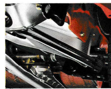
フロントスタビライザ コーナリング時の踏んばりを強く、安定性を高めます。高速走行に欠かせない装備です。(1200SX以上)
