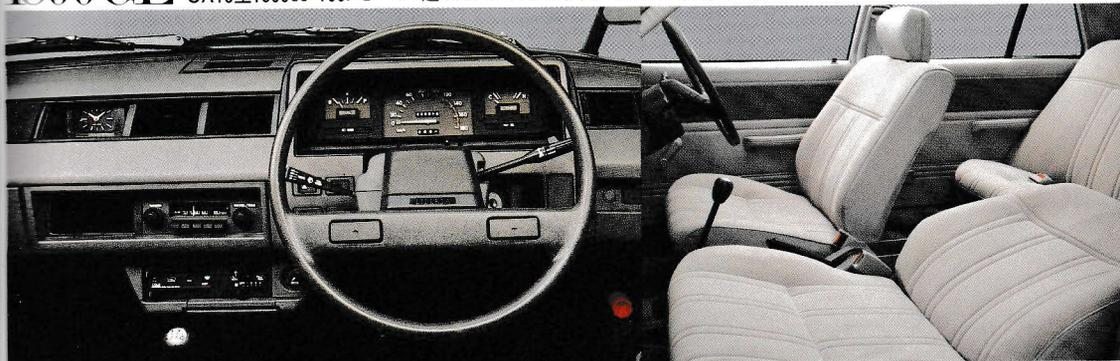
**1800SX** CA18型1800cc・100PS ●OD付5速フロアシフト●ニッサンマチック・フロアタイプ
