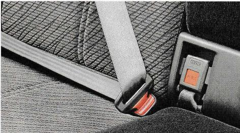
後席のシートベルトバックルに自立式を採用。シートベルトを装着しやすくし、シートアレンジ後もちゃんと元の位置にあるようにしている。しかもALR（オートマチック・ロック・リトラクター）付きだから、全部引き出してしまうと収納する方向にしか動かない。途中で引っぱり出そうと思っても動かないから、シートベルトで固定するタイプのチャイルドシートをがっちり固定できる。数ある日本車の中でも、LEGACYはかなり早い時期にこの機構を採用した。
