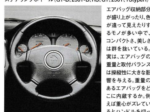
エアバッグ収納部分が盛り上がったり、色が違って見えたりするモノが多い中で、コンパクトさ、美しさは群を抜いている。実は、エアバッグの重量と取付バランスは操縦性に大きな影響を与える。重量のあるエアバッグをどこに内蔵するか。例えば重心がズレているとハンドルを切つ
