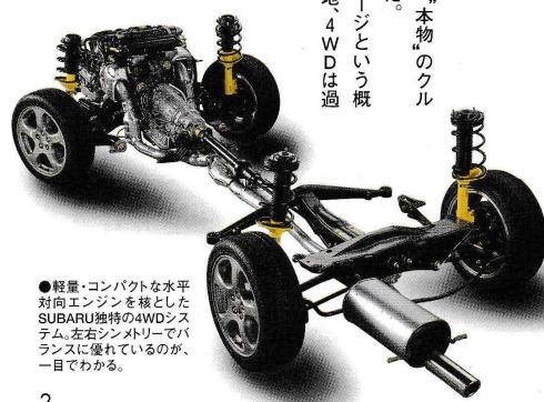
●軽量、コンパクトな水平対向エンジンを核としたSUBARU独自の4WDシステム。左右5インチでバランスに優れているのが、一目でわかる。
