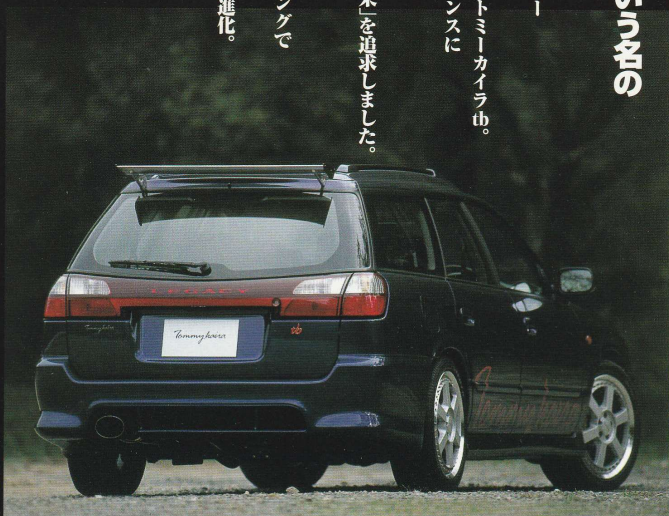
リアウィングは、軽量のアルミニウム製で軽やかに風を切る
