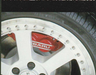
グレードアップしたストップピングパワー。 4ボッド対向ピストンのブレーキキャリパーを標準装備 (F)
