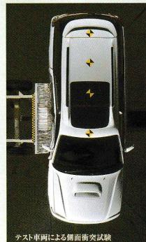
テスト車両による側面衝突試験
