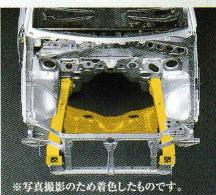
サイドフレーム構造：水平対向エンジンを縦置きに搭載するレガシイは、サイドフレームがバンパーまでストレー。またフロントサスペンションの取付け位置にクロスメンバーセットを設置。これにより、衝突エネルギーの吸収力とキャビンが壊れないように守る強度を両立させています。
