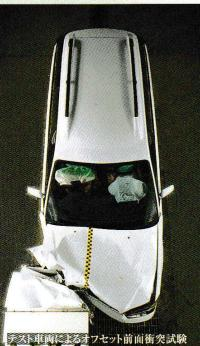
テスト車両によるオフセット前面衝突試験
