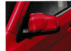
電動格納式リモコンドアミラー (カード・GSR) (RSは電動リモコン式・ブラック)
