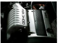
ミッドシップに搭載されるCOA-IIIの夢 エンジンは、1.60DOHC16バルブ・イッ タークーラー付ターボ。ISUZU先進(、) セラミック技術を導入し、吸・排気バルフの シリンダーライナー、タービンブレード等っ 理想の素材・セラミックを採用。ハイパワー ハイレスポンスでしかも軽量・コンパクト、デ 異的なパワーを引き出すことも可能です。 次代のパワーユニット・セラミックエンジす。 …。独特のエキゾーストノートをとどろか、 る日も間近です。
