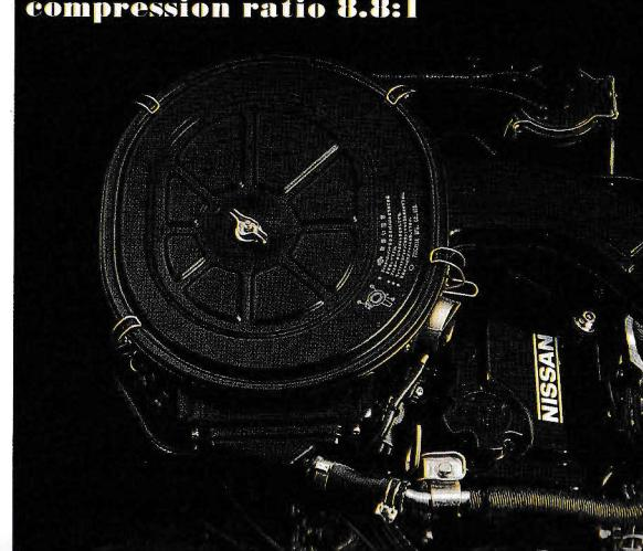
抜群のトータルバランス—CA18S型エンジン。驚異的な小型・軽量。ハイパワーと低燃費、そして実用域で優れたトルク性能。CA型エンジンは、エンジンに求められる諸性能を高い次元でバランスさせた世界でも例を見ない傑作エンジン。最高出力100ps/5600rpm、最大トルク15.2kgm/2800rpm。圧縮比8.8。10モード燃費(運輸省審査値)14.0km/l。60km/h定地走行(運輸省届出値)22.0km/l。シリンドラーブロック、クランクシャフトの剛性を高め静か性も大幅に向上。最も至難とされていた、小型・軽量・低騒音を見事に両立。R-Xに新搭載。
