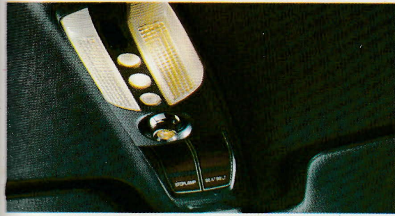
オーバヘッドコンソール ストップランプ断線、シートベルトインジケータ、ランプ類を組み込んであります。(2000GSL、GSR、スーパーサルーン)
