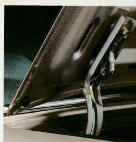
リッドアンテナ トランクのリッド部がアンテナとして機能。出し入れの必要がなく折れる心配も不要。
