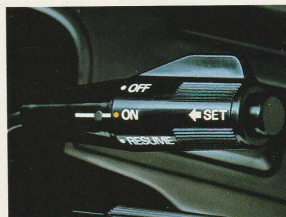
定速走行装置 40~100km/h間でセオ可能。その間アクセルは不要。高速道路等の運転に便利。2000ロイヤル・2000スーパー・2000GTLに標準装備。
