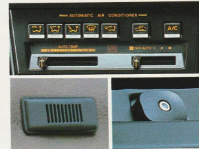
オートエアコン 一度セットすれば、コンピュータが室温をキャッチ。自動的に温度調節する高性能エアコン (2000ロイヤル・2000スーパー・2000GTLに標準装備) 。
