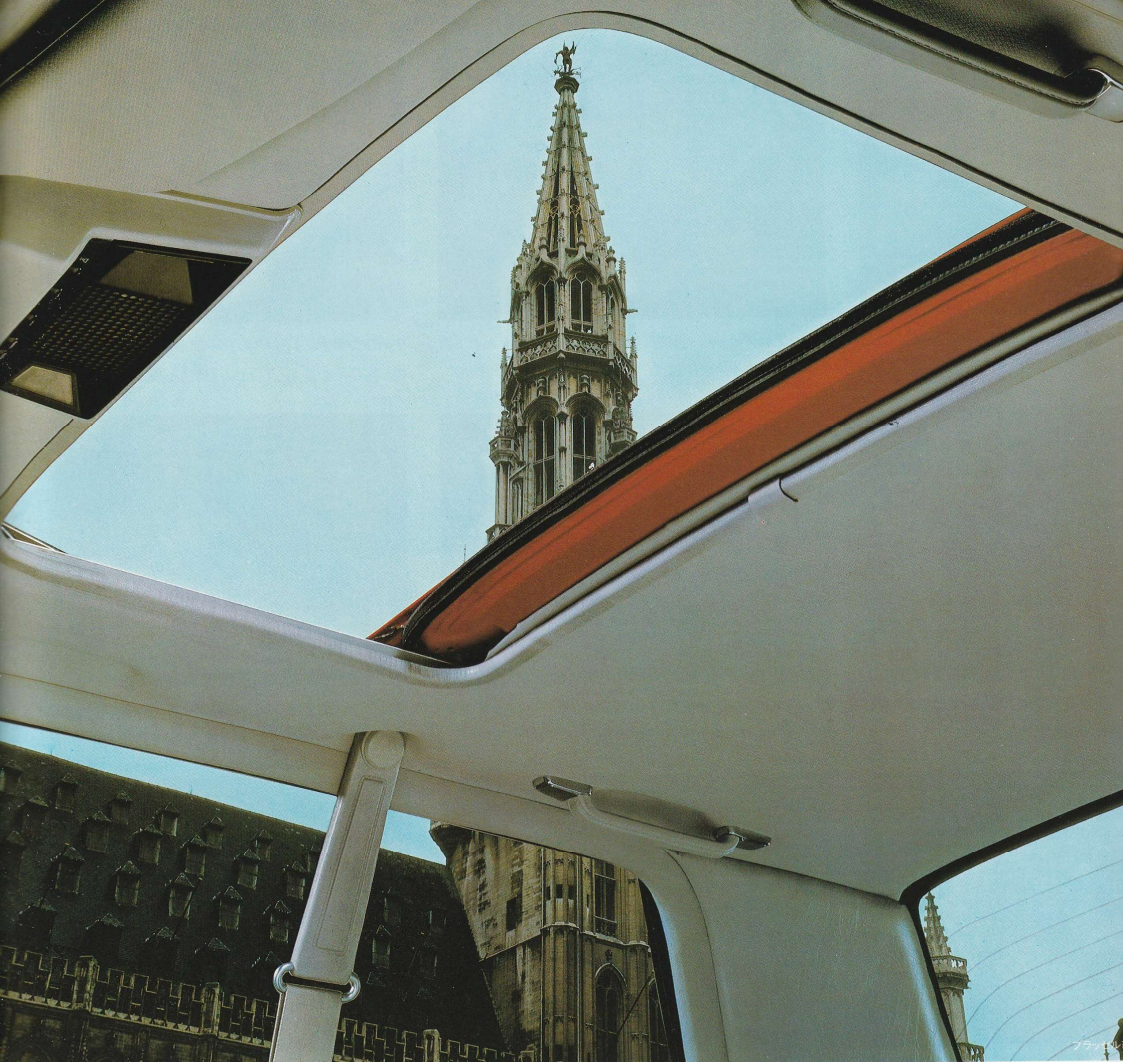
電動式サンルーフ ルーフ前部に設けられたスイッチで、自由自在に開閉できるスライド式のサンルーフです。2000GSRと1800GTに標準装備。
