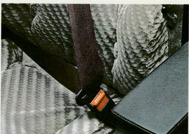
テンションレギュサ付ELRベルト 衝撃を感じた時に、自動的にベルトをロック。また使用時の圧迫感も追放 (標準) 。
