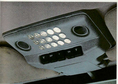
ルームランプ遅延消灯 ドアを閉めた後もルームランプはついたりまま。約20秒 (ドアを閉めた後) 後、自動的に消える機構です。
