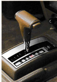
●マイコン制御OD付4速フルロックアップオートマチック(2000cc車)セレクターノブ
