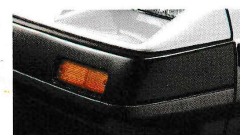
●ショックアブソーバーを内蔵した衝撃吸収式バンパー。約8km/h以下の軽衝突に能力を発揮。
