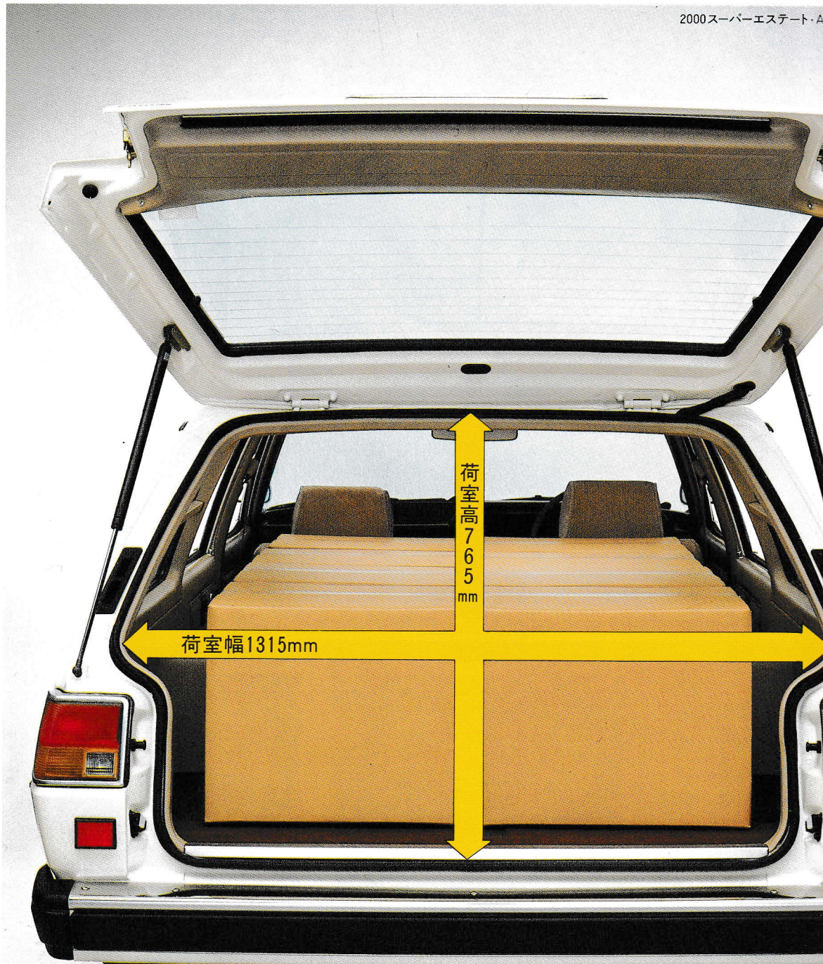
テールゲートストラット 圧縮ガス封入式ですので、いつもテールゲートの開閉は軽くスムーズです。
