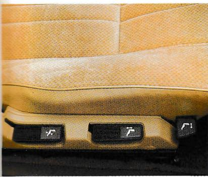
集中シートコントロール チルト機構、シートスライド、リクライニングなどの操作レバーを一か所に集中。
