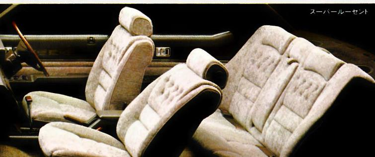
広くとりました。心理的な圧迫感もほとんど感じません。シートに身体をゆだねれば、どのような体型の方もぴったり。まず180mmというスライド量をもつ前後スライド調節機構をはじめ、リクライニング機構、クッション角度を調整できるシート上下アジャスター、そしてハンドルとの位置関係はチルト・ステアリングでジャストフィット。腰部の疲労を柔らげるランバーサポートも効果的です。ヘッドレストは前席は前後調節式(スープラックス)、後席は回転式(スープラックス)を装備。前席シートベルトは新設計のスライド・インナー・アンカー式ELRタイプを採用。体に無理なくシートベルトを装着できます。ステアリングホイールはクリップ感のよい4本スポークキャストウッド(スープラックス以上)。ステアリングギアはポールナット式を採用。トランスマッisionは、1G-EU型エンジン車に5速マニュアル(スープラックス以上)とオーバードライブ付4速オートマチック(スープラックス以上)。それに13T-U型エンジン車(1770cc、水冷直列4気筒)に4速マニュアル(スープラックス以下)と3速オートマチック(スープラックス以下)です。
