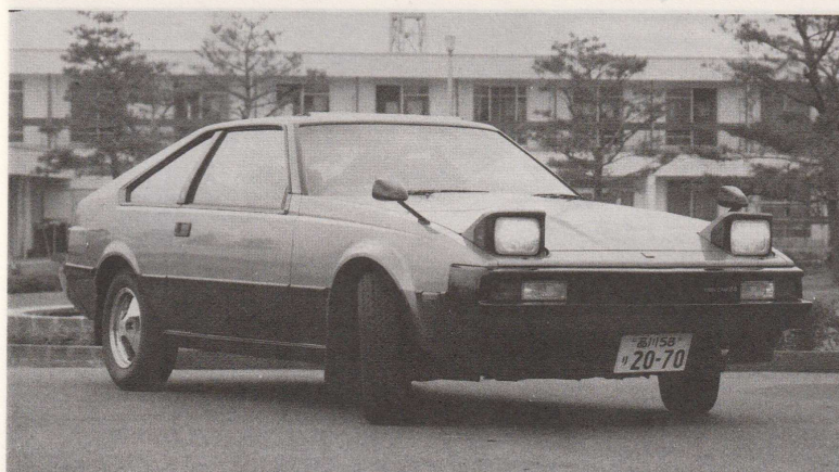
5ナンバーの中で最高の性能を追求した直6・4バルブDOHCがセリカXXに加わった。スタイリングは従来のまま。余裕の2.8リットルインカムにない、パンチのきいた走り流を組んだ車だ。ギア比もかなりローギアード設定。2800GTより車重は25kg軽い。
