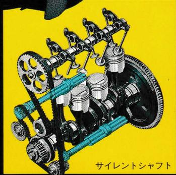
あのサファリ、サザンクロスをはじめ、幾多の国際ラリーを制した本格派の心臓＝OHCツインキャブの4G32型サターン。三菱独自の、またサターン伝統のロングストローク。MS(三菱)燃焼室。クロスフローポートの吸排気システムなどが高度にマッチングして、100ps・13.5kg-mの高出力、高トルクを発揮。加えて高回転域で強烈なパンチ力をくり出す一方、2000rpm前後の実用回転域でもフラットなトルク特性を提示。スポーティ派のGSRで
