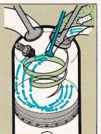
発表と同時に注目を集め、高い評価を受けたMCA-JET。その原理は、新設されたジェットバルブから超希薄な混合気、または空気が燃焼室に送りこまれ、吸気バルブからの混合気をミキサーのようにかき混ぜる。その結果超希薄燃焼を可能にし、低公害でありながら、低燃費・高性能を実現している。
