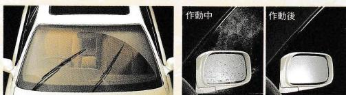
フルエアワイピングシステム 扱拭角をLoモード間欠時には、より広域に。Hiモード時には自動的に補正してオーバーランを防止します。
