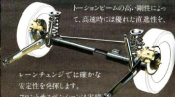
トーションビームの高剛性によって、高速時には優れた直進性を、レーンチェンジでは確かな安定性を発揮します。フロントサスペンションは実績のあるストラット式を採用。リヤサスペンションとの最良の組み合わせで、さらに優れた走行性能を約束します。
