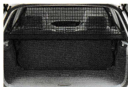
セパレーションネット (将来予定されている欧州積荷移動防止基準レベルを満足)
