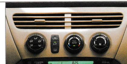
オートエアコン 個性的で使いやすい、リングダイヤル式のコントロールスイッチを採用。広々とした室内のコンディションを、いつでも快適な状態に保てます。
