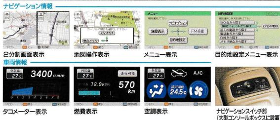
ワイドマルチAVステーションII(GPS\*1ボイスナビゲーション\*2付) オーディオ・ビジュアル\*3・ナビゲーションの多彩な機能を、コンパクトにまとめたコンポーネント、それがワイドマルチAVステーションIIです。ワイド放送に対応する大型のインチャイロ・マルチディスプレイに、ナビ画面やタコメーター・燃費・空調などの車両情報、オーディオ、テレビの作動状態などが表示されます。GPSボイスナビゲーションは、GPS衛星から発信される信号と自立航法により、車両の現在位置を把握し、現在位置から目的地周辺までの推奨ルートや交差点での進路などの各種ナビゲーション情報を音声と画面で提供。タイムリーな交通情報を入力できるVICIS\*4システム(販売店装着オプション)や、トヨタ独自の情報センターから「電子メール」などさまざまな最新情報をオンラインで受けられるトヨタ情報通信システム・モネ\*5\*6(販売店装着オプション)にも対応しています。
