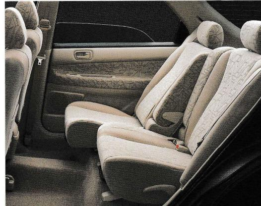
5:5分割可倒式リヤシート(シートスライド&リクライニング機構付) 左右それぞれに、最大170mmのスライドとリクライニングが可能。左右独立したアームレスト(カッパホルダー内蔵)も、シートと一緒に移動します。また、リヤのヘッドレストは前後・上下調整式です。
